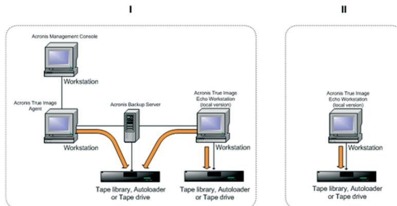
**Abb. 1: Zugriff auf Bandlaufwerke, Tape Libraries und Autoloader (Schema)**
