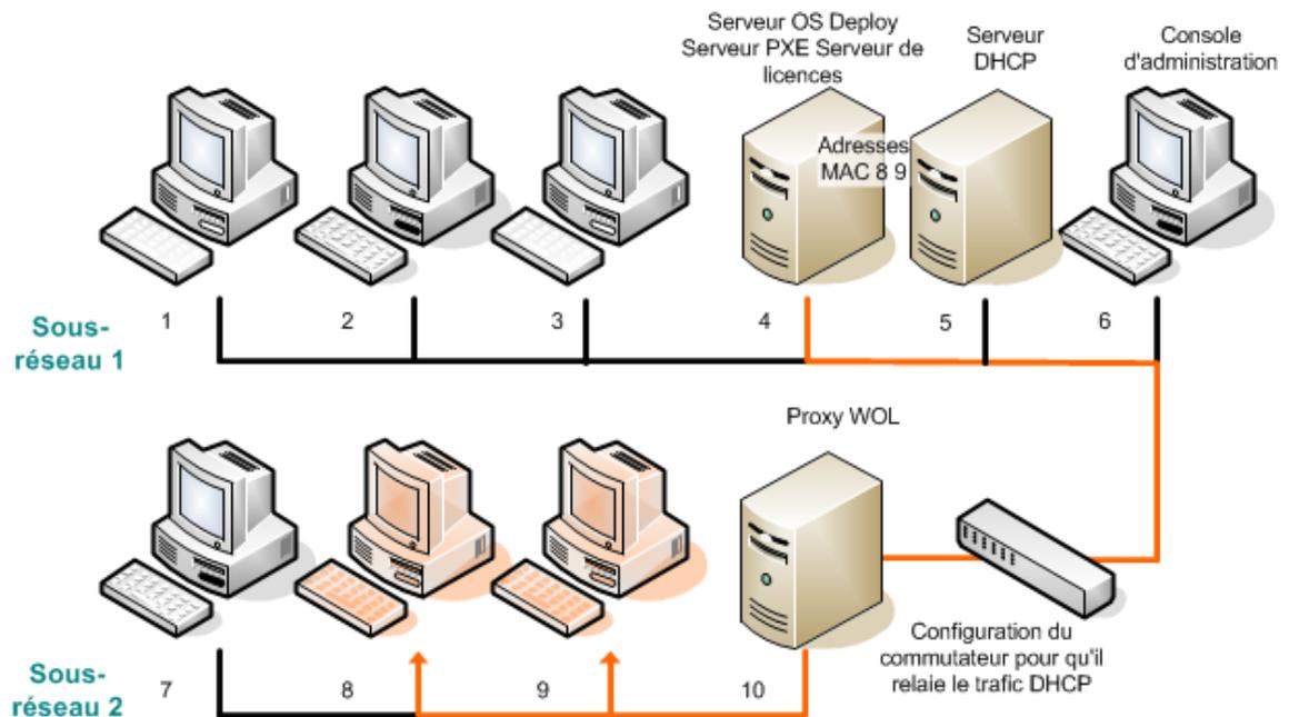
Déploiement dans un autre sous-réseau en utilisant Acronis Wake-on-LAN Proxy. Le commutateur réseau est configuré pour relayer le trafic PXE et le trafic DHCP.
