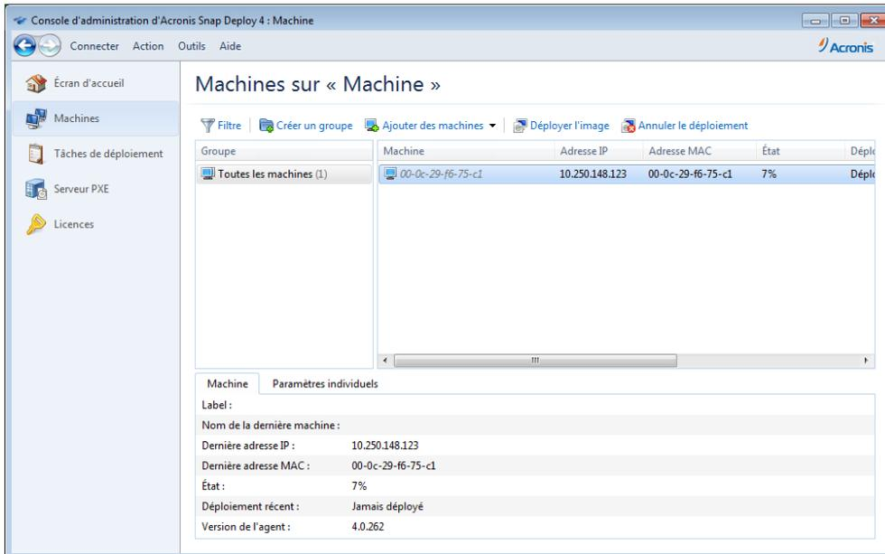
Affichage de la progression du déploiement sur la machine avec Acronis Snap Deploy 4
