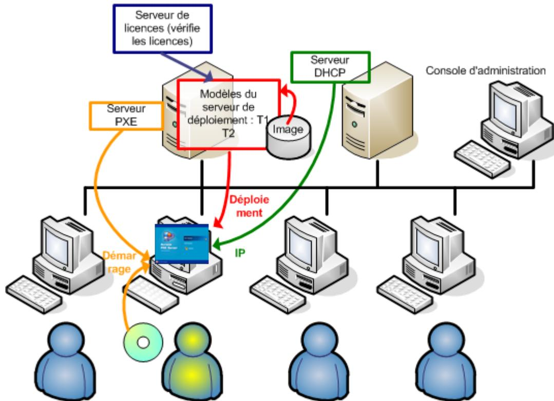
*Mode de déploiement lancé par l'utilisateur : un utilisateur démarre le déploiement*
