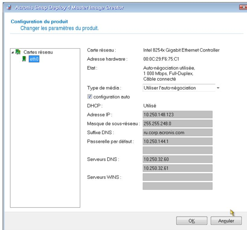
*Configuration d'Acronis Snap Deploy 4 Master Image Creator : paramètres du réseau*
