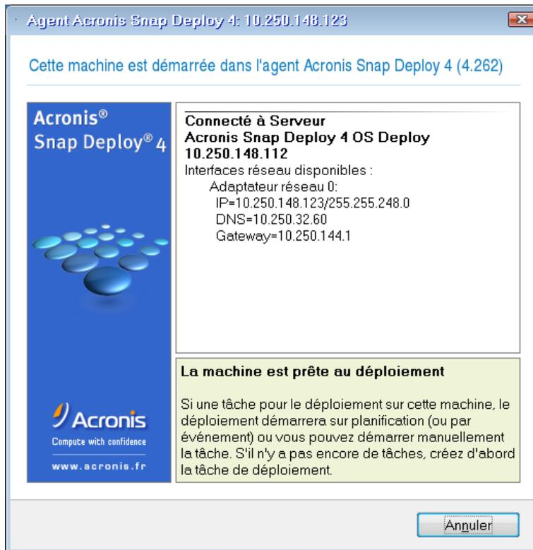
**Détails.** La machine cible est prête pour le déploiement lorsqu'elle se connecte au serveur Acronis Snap Deploy 4 OS Deploy. Ce serveur fait partie d'Acronis Snap Deploy 4. Si la machine ne se connecte pas au serveur, vous devez ajuster les paramètres réseau tel que décrit dans « Démarrage des machines cibles ».
