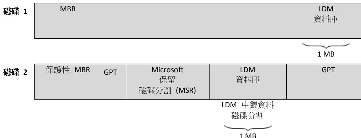
在 MBR (磁碟 1) 和 GPT (磁碟 2) 磁碟上組織的動態磁碟。
